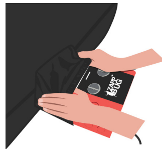
Etendez le tuyau autour de l'unité de chauffage (respectez les signes "ne pas couvrir"!)
