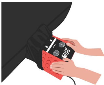
Placez la base de l'unité de chauffage dans le tuyau
